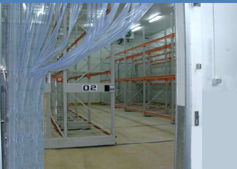
(Mobile Rack for Cold Room) (ใช้งานที่อุณหภูมิ -25°C)
